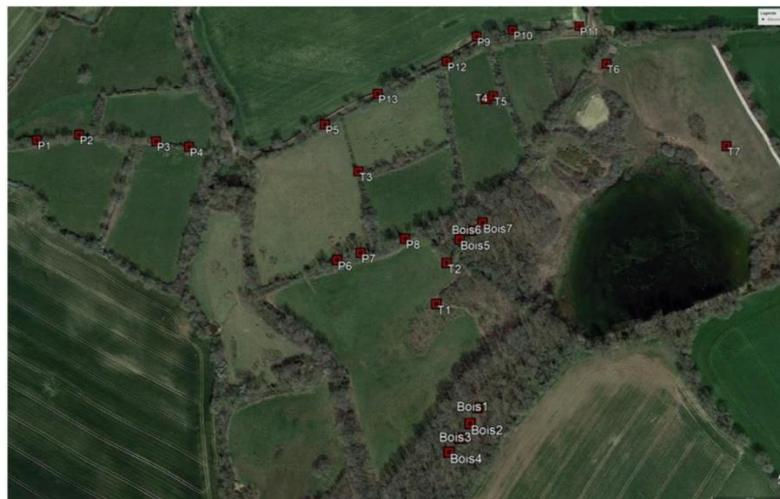
Figure 2.14 : Localisation des enregistreurs de température dans les profils de haies et des boisements de la RNR du Bocage des Antonins.
