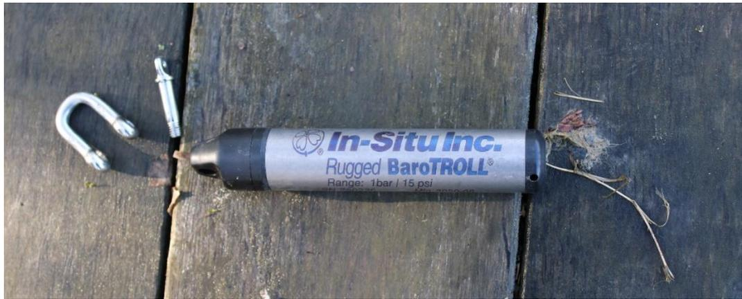
Figure 41 : Sonde piézométrique installée au niveau du dispositif de vidange de l'étang des Forges. © Alexandre Boissinot.
